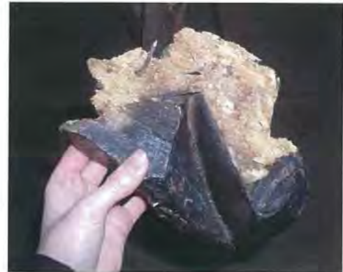
Un morceau de bois cassé net au niveau du collage. lors de la dernière procession, a permis de constater la présence de clous entre les deux éléments assemblés.
