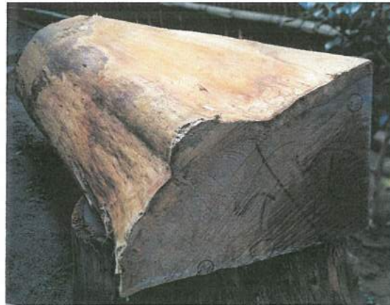
Partie d'un tronc d'hinoki, découpée en JU-JI, c'est à dire en forme triangulaire. © Komparu Nobutaka et Masuda Shozo, Nomen nûmon (introduction aux masques Nô), Heibonsha, 1984, p.138
