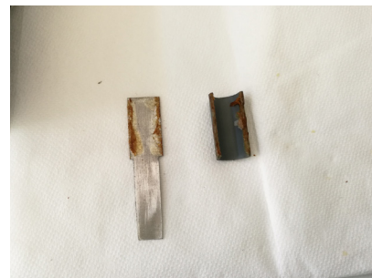
Plaque et demi-tube avec les liants de collage
