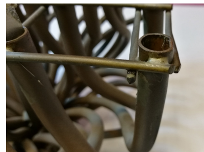
Assemblage par une soudure brasée
