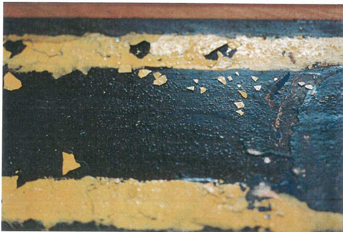
Ill. 21 : Rascalon début XIX e siècle : Guichet de piano-forte Couche de fond grossière et granuleuse - Vue du revers
