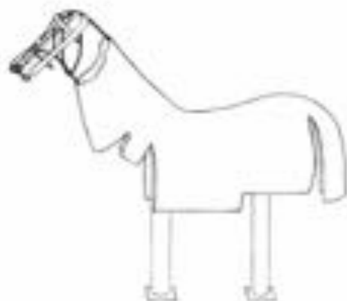
Armature proposée pour le soclage de l'armure de cheval conservée au musée de Lyon © 2007 Emille Blanc
