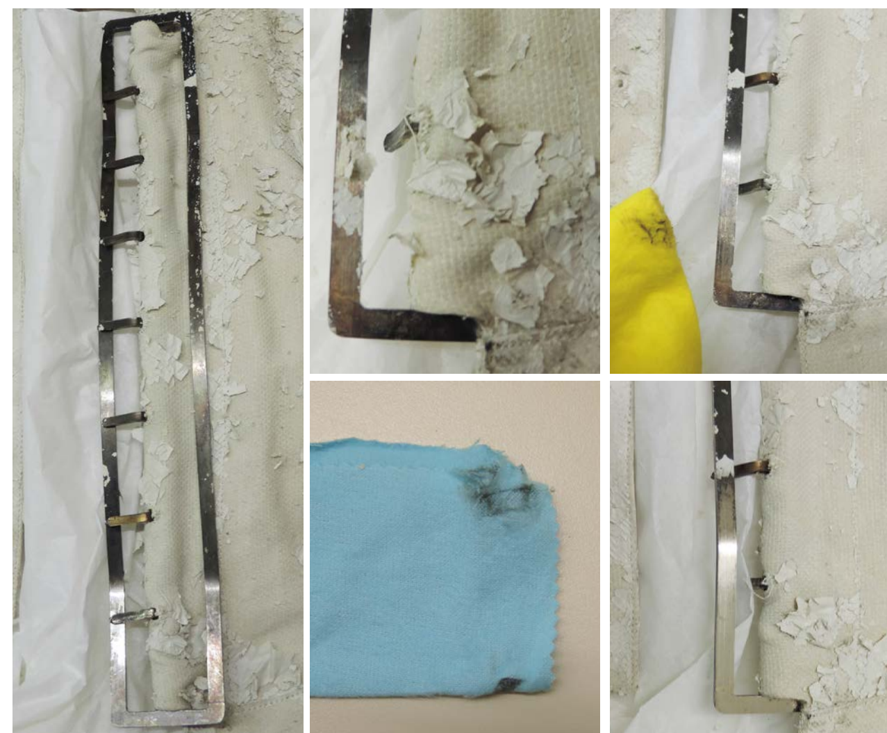
Gauche: État actuel de la boucle. Centre supérieur: Détail du verso du coin droit, où le test de nettoyage fut effectué - état avant traitement- Image supérieure droite: retrait des écailles de PUR à l'aide d'un chiffon doux. Centre inférieur: résidus noirs laissés sur le chiffon de soin de l'argent- Image inférieure droite: résultat après retrait de la couche de noircissure.
