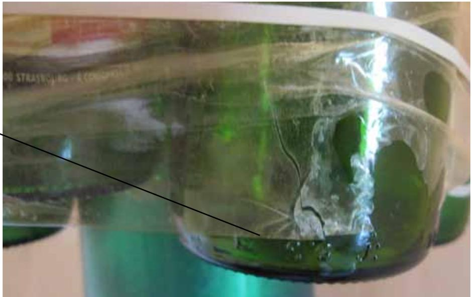
Photographie de détail du ruban adhésif fissuré, qui enserre les bouteilles de bière.
