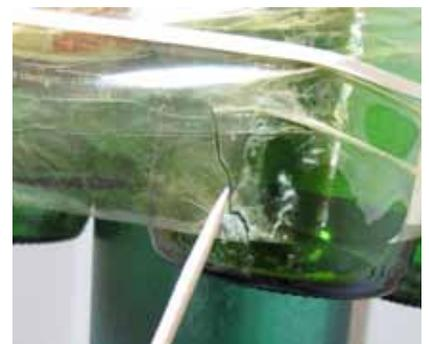
Détail dde la fissure présente sur une bouteille de bière, rangée basse des bouteilles de bière.
