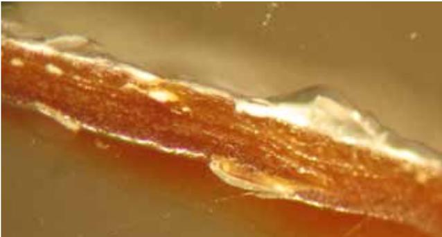
Deux photographies de détail de la stratigraphie réalisée avec un échantillon de colle contact
