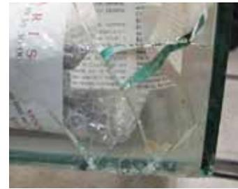
Détail de la fissure du verre, localisée sur l'un des quatre angles inférieurs.
