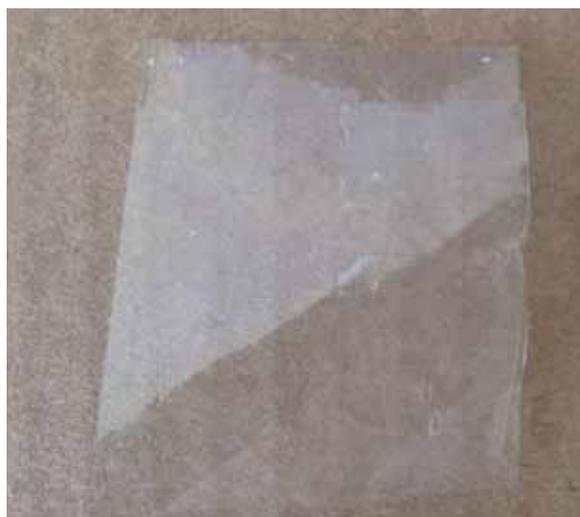
Photographie de détail, test de consolidation d'un ruban adhésif transparent avec du polyester adhésif en ruban simple face.
