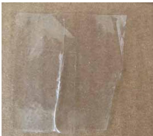
Photographie de détail test de consolidation d'un ruban adhésif transparent avec de la Béva film ®.
