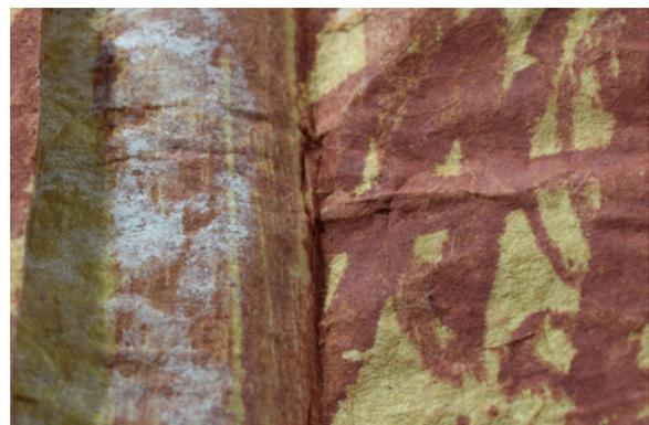
**Perte d'adhérence** au niveau des zones d'assemblage et **dessiccation de l'adhésif**, visible sous la forme d'un résidu blanc
