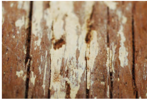
8. Arrière de l'oreille gauche, à proximité du manchon de cuir, fissuration du bois dans le sens des veines.
