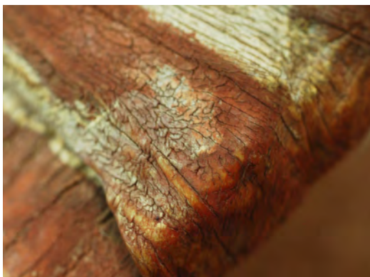
34. Avant, détails du réseau de craquelures du manchon de cuir au niveau de la fracture de l'oreille gauche.
