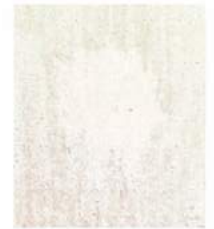
Tache claire produite par une goutte d'eau sur la couche picturale de test.
