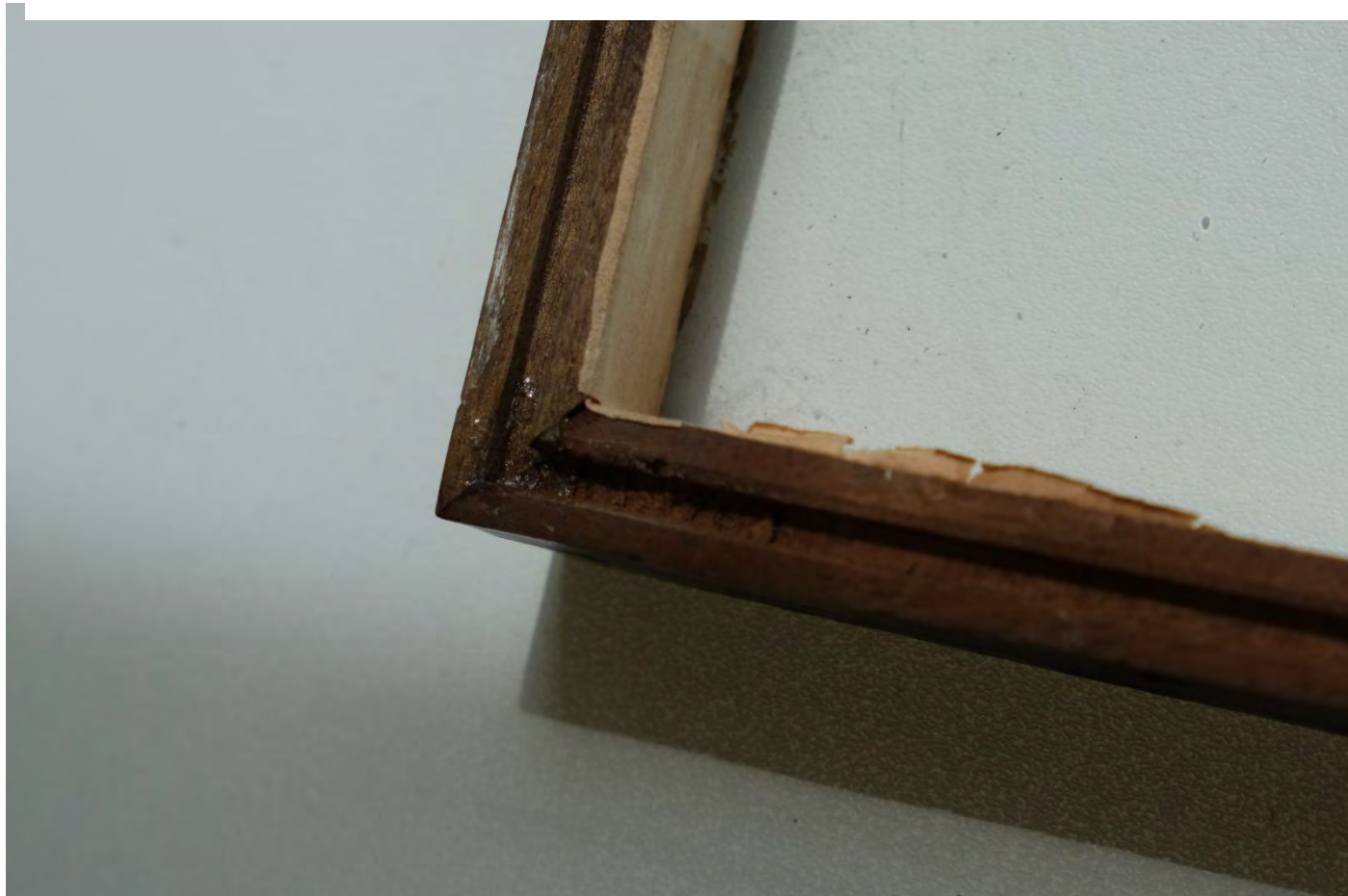
Figure 32 : Morceau de papier oxydé et déchiré sur la face intérieure du couvercle de la boîte 20 avant traitement, lumière artificielle frontale, avec un appareil Fujifilm XT30 dans l'atelier d'entomologie des réserves du Musée des Confluences le 12 Mars 2021, crédit GEORGY E.
