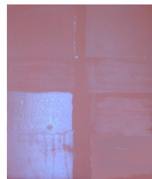
Le tableau test du Mowital 60H et du silicone.
