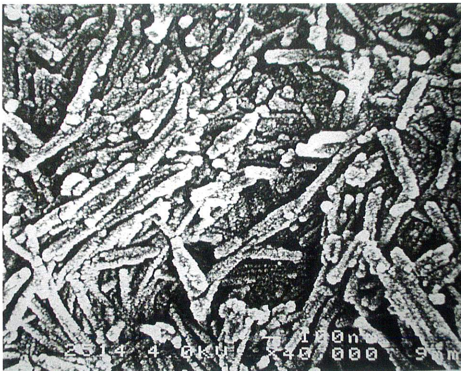
Fig. 37 : photo en microscopie électronique à balayage , rubans de l'attapulgite dont l'apparence lui donna anciennement le nom d'argile fibreuse. © l'Oréal
