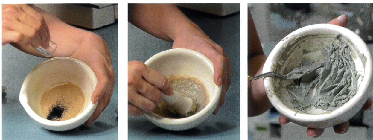
Le mélange de l'argile de Sacalum et de l'indigo du Mexique broyé et obtention d'une pâte après broyage et malaxage au pilon et à la spatule .
