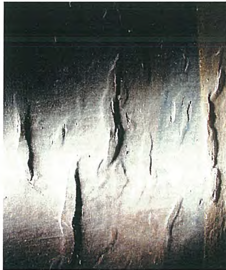
2. Déformations et incisions dans la partie «hors champ» du lé droit
