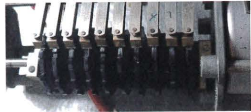
Le bloc de cames au moteur - CT©
