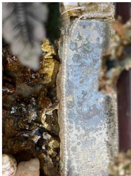
Figure 81: Détail corrosion et rupture fil
