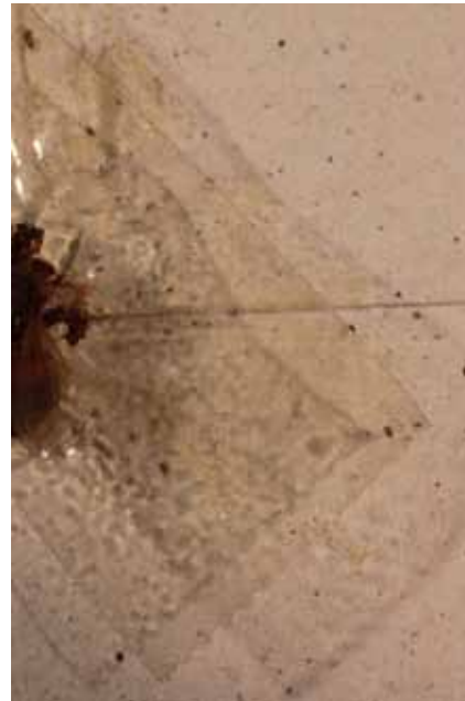
L'adhésif du ruban, décollé du support papier, est en cours d'oxydation et forme des gouttellettes à l'aspect huileux, collant et jaune
