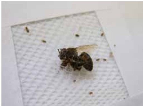
Test moustiquaire Duranet : Quelques vermoulures apparaissent sous la tête de l'abeille après 38 jours d'essais, mais sans évolution. Toutes les larves sont mortes sur la moustiquaire Duranet®.
