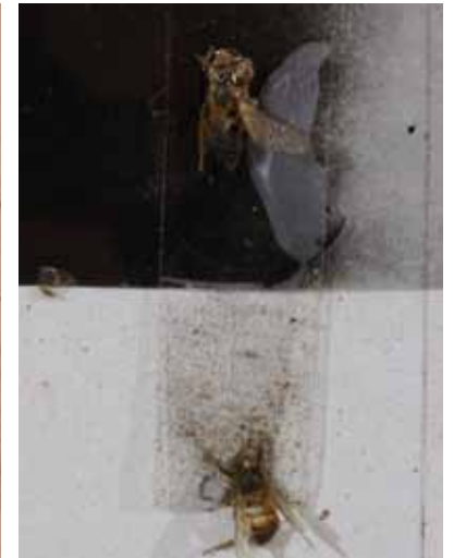
La partie du ruban autocollant collée sur le Rhodoid® (partie supérieure) n'a pas perdu son adhérence et ne semble pas avoir subi d'altération chimique, sauf un blanchiment sur une zone décollée
