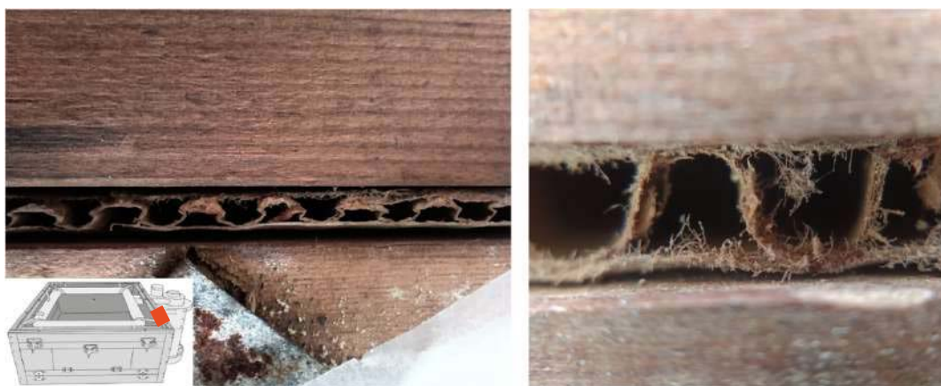
Fig.13 Détail de l'isolation en carton, à droite un grossissement x25 ©Gabrielle Chailloux
