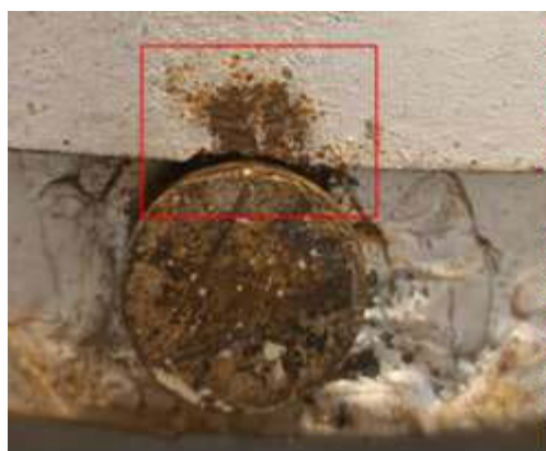
Fig. 103 Détail du traitement des produits de corrosion d'un alliage ferreux, sur la lampe, avant traitement. ©Gabrielle Chailloux
