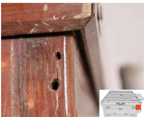
Fig. 74 Détail des soulèvements et altération du bois de la caisse 1 ©Gabrielle Chailloux
