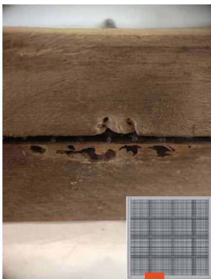
Fig. 95 Détail des galeries et trous d'envol sur la grille N°3 ©Gabrielle Chailloux
