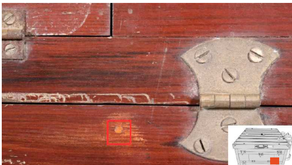
Fig. 66 Détail du mastic de rebouchage sur la face ©Gabrielle Chailloux
