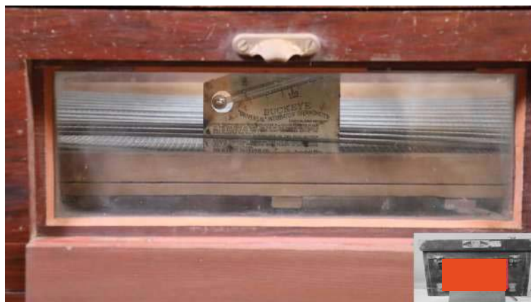
Fig. 20 Vu du thermomètre, sur les grilles, à l'intérieur de la couveuse, par la vitre de la première trappe ©Gabrielle Chailloux
