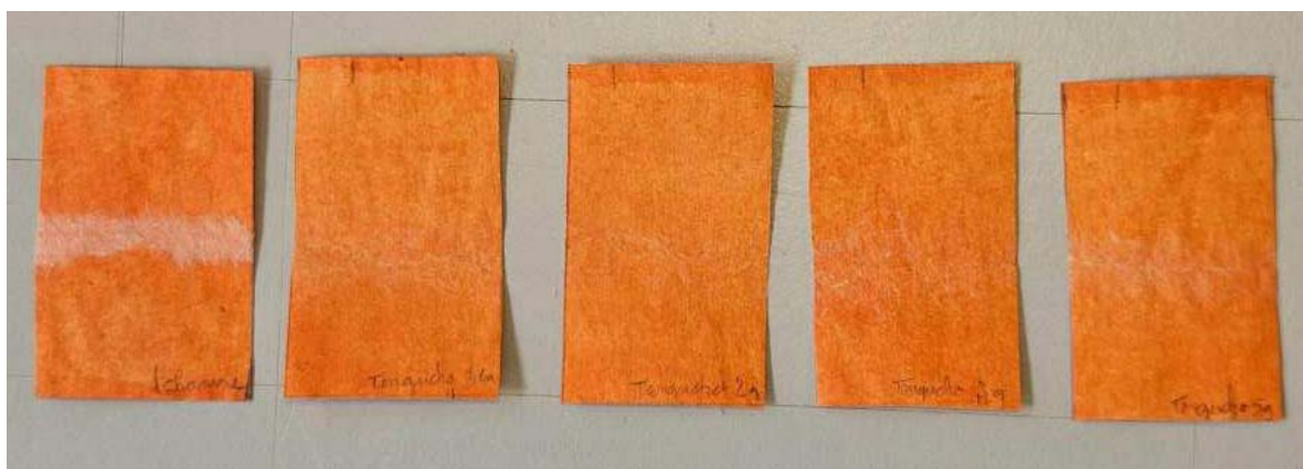
Consolidation de déchirures sur le papier Fabriano teinté à l'acrylique. Lumière directe.
