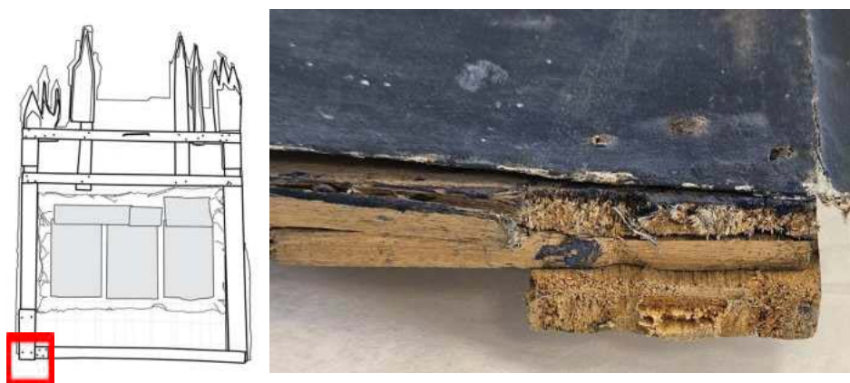
Tourillon arraché sur le coin inférieur senestre de 28(A)
