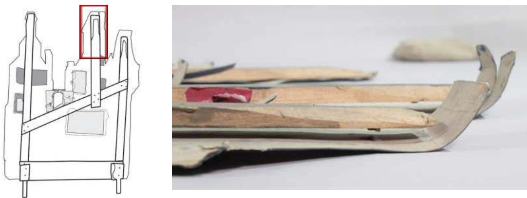
Désolidarisation importante sur le haut de 31(D)
