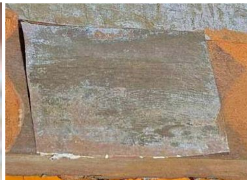
Broquette oxydée sur le patin et feuille ternie de l'écran
