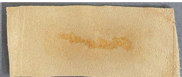
Fig. 70 : Photo de l'éprouvette vue de dos après le retrait au batonnet de coton umecté d'éthanol
