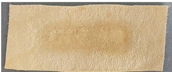
Fig. 69 : Photo de l'éprouvette vue de face après le retrait au batonnet de coton umecté d'éthanol
