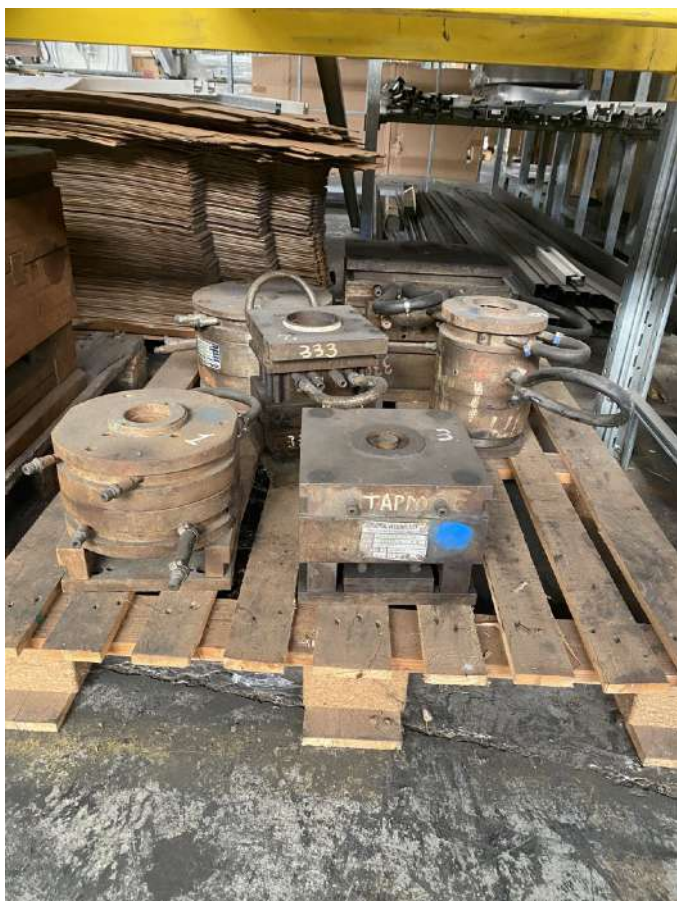
Figure 87 : Moule pour l'injection par moulage des pièces pour la fabrication du portemanteau Planta. ©Z.Pacreau.
