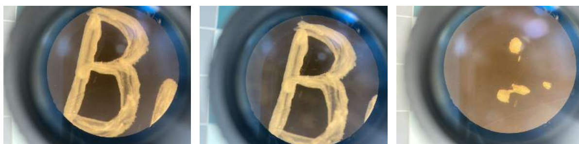
Figure 56 : Test de marquage acrylique blanche, prise de vues binoculaire, avant/pendant/après. De gauche à droite : détail avant, détail après test d'adhérence et test de retrait à l'eau déminéralisée, détail après test de retrait à l'éthanol. ©Z.Pacreau.
