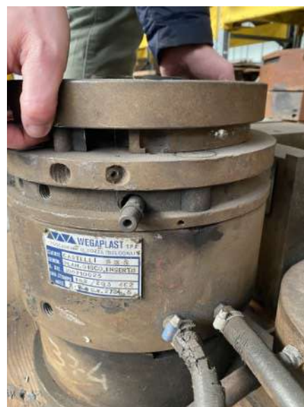
Figure 43 : Moule en métal d'origine pour injection. Archive d'Anonima Castelli. ©Z.Pacreau.
