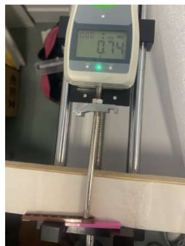
Figure 54 : Test de clivage sur éprouvette en LEGO. ©Z.Pacreau.
