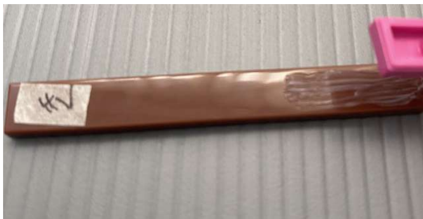
Figure 55 : Test de collage avec l'acrylique Lascaux 498 HV sur éprouvette en LEGO. ©Z.Pacreau.
