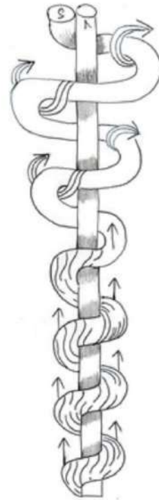
Fig.71 : Schéma tressage à deux brins circulaire.
